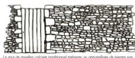
Le mur de moellon calcaire traditionnel présente un appareillage de pierres non cossées. C'est-à-dire ne dépassant pas de lignes horizontales régulières.
